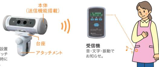
赤外線センサーをベッドやドアなどに取り付けて、起き上がりや離床、特定の場所への移動を検知、無線で受信機にお知らせします
